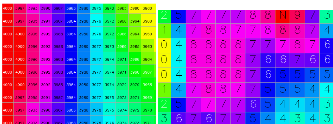
Figura 6.20: MDE obtenido multiplicando por 10 la altitud de las curvas de nivel y mapa de pendientes resultante
