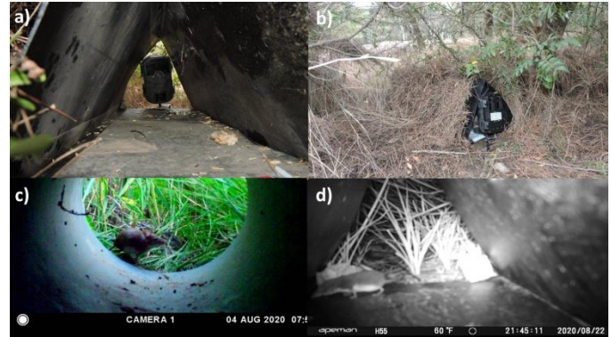
Figura 8. Adaptación de la técnica de fototrampeo aplicada a la detección de micromamíferos. a) Vista interior de una cámara instalada en un túnel portátil de PVC; b) vista exterior de la misma cámara instalada en túnel y camuflada; c) fotograma de un ratón de campo ( Apodemus sylvaticus ) detectado en una cámara túnel; d) fotograma de un musgaño de Cabrera ( Neomys anomalus ) detectado en una cámara túnel instalada sobre el cauce de un río (Autor: Santiago Conesa).
