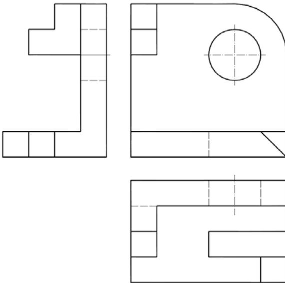
**Ejercicio 2:** (3 puntos) Se da una pieza definida por las tres vistas principales: alzado, planta y perfil derecho (sin acotar). Dibujar una perspectiva axonométrica cualquiera de dicha pieza sin sujeción alguna a escala. Podrá operarse indistintamente a pulso o con instrumentos.
