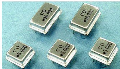
Figura 1.5.- Módulos osciladores de cristal de cuarzo.
