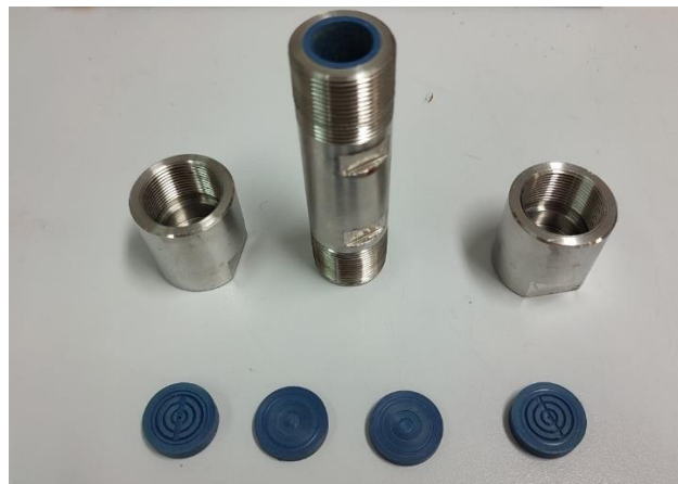
Figura 4. 5: Columna de suelo empleada y sus componentes. Fuente: elaboración propia.
