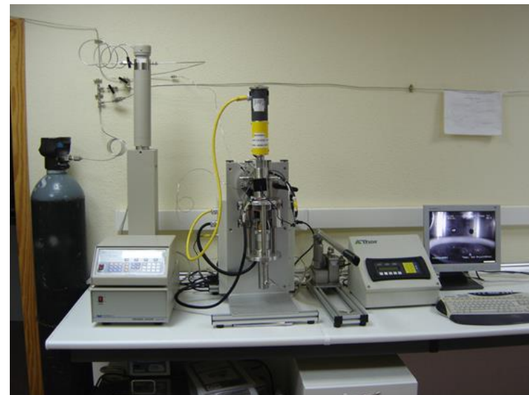
Equipo experimental para la medida de solubilidad de compuestos en medio supercrítico
