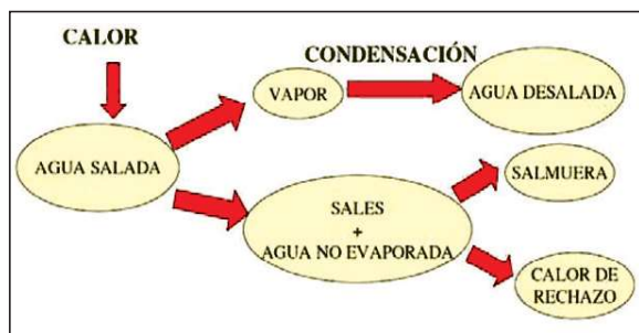
Gráfico 6: Esquema funcionamiento planta destilación (Fuente: Begoña Moreno Escobar, UGR)
