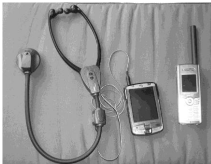
FIGURA 7.- PROTOTIPO DE ESTETOSCOPIO INTELIGENTE E-PHONO
