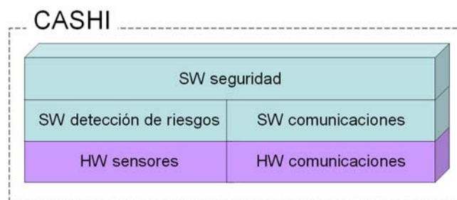
Figura 2. Esquema modular del sistema CASHI
