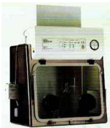
Figura 5. Cabina de seguridad microbiológica de clase III
