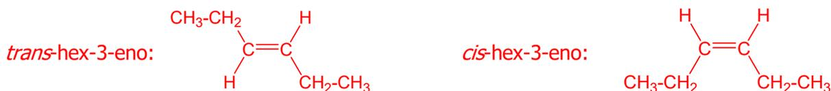
Isomería espacial geométrica (*cis-trans* o *Z/E*), porque cambia la disposición en el espacio de los sustituyentes en un alqueno
